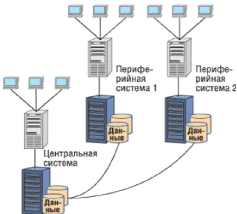
Рис. 1.5. Пример технологической архитектуры комплекса из трех легких ERP-систем.
