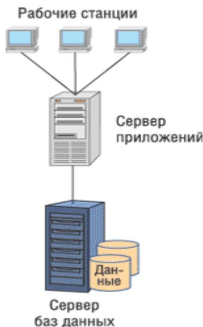
Рис. 1.4. Технологическая архитектура легкой ERP-системы
